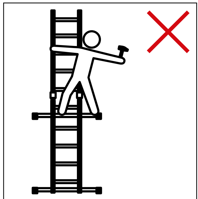
Abb. 13 Gebrauchsrisiko mit einer zweiteiligen Schiebeleiter mit trennbaren Leiterteilen.
